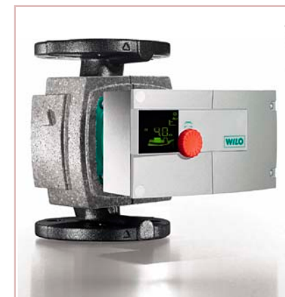
Fot. 2. W pompach nowej generacji zastosowano szereg rozwiązań różniących ich konstrukcję od wcześniejszych modeli. Celem modyfikacji jest między innymi poprawienie sprawności tych pomp. Jednym z przykładów takiego rozwiązania jest zastosowanie tulei rozdzielającej mokrą część wirnika od stojana z tworzywa sztucznego zamiast wcześniej stosowanej ze stali nierdzewnej.
